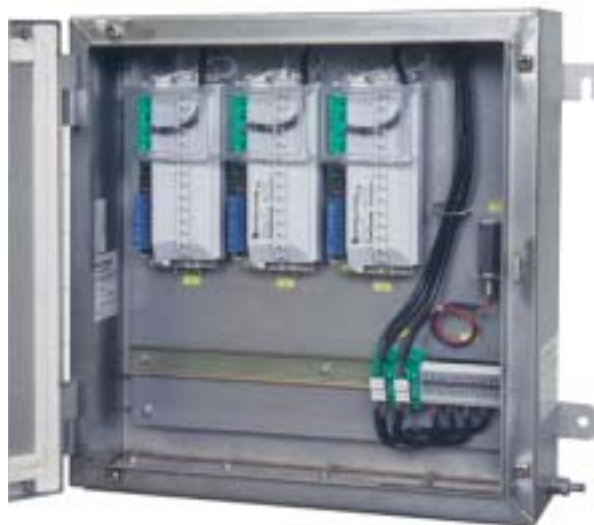
Cassette di distribuzione Fieldbus in acciaio Inox per la connessione di 12 strumenti Fisco/Entity mediante l'utilizzo di 3 unità Field Barrier.
